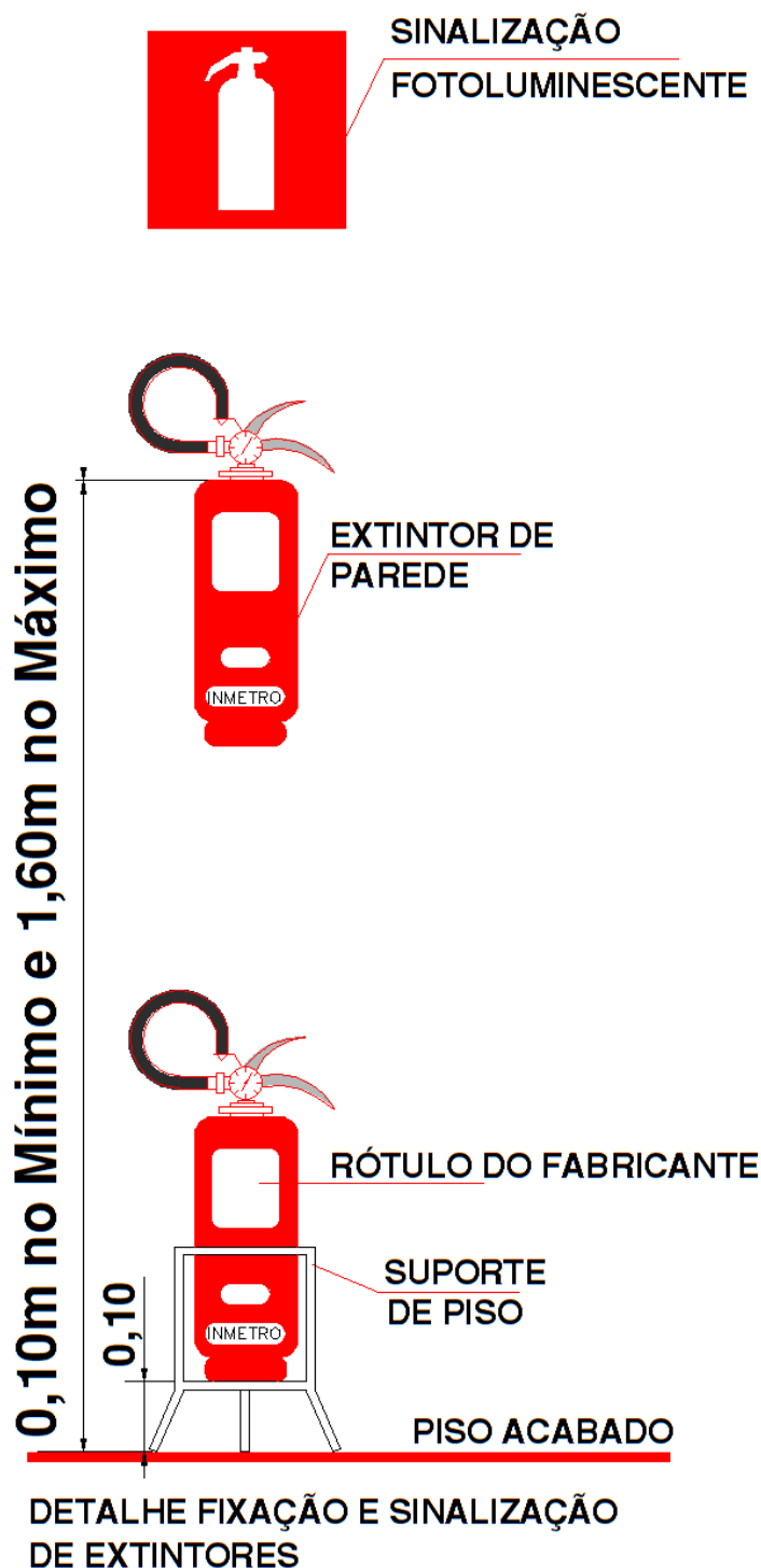
Figura 1 - Fixação de extintor
